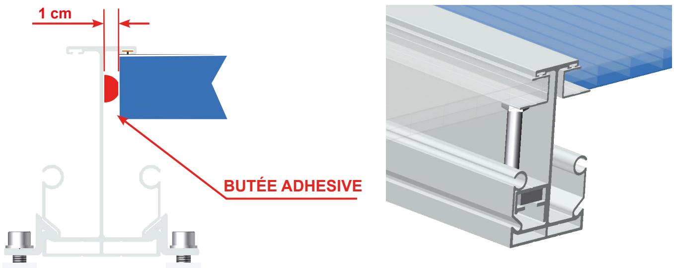
Les panneaux et les profils inter panneaux s'insèrent dans la structure en les faisant passer d'un côté à l'autre.
