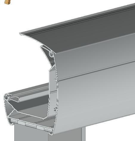
Monter tous les profils sur le coffre bas, ils viennent simplement se coulisser. Puis insérer les pieds en faisant coulisser la platine ST3402.
